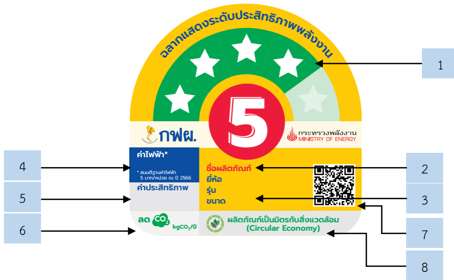
รูปที่ 4 รายละเอียดฉลากแสดงระดับประสิทธิภาพพลังงาน (ขนาดจริง : กว้าง 72 มม. สูง 72 มม.)
