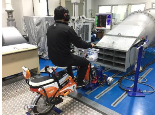
รูปที่ 4 การทดสอบจักรยานยนต์ไฟฟ้าในห้องทดสอบ
