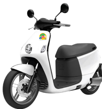
รูปที่ 9 การติดฉลากแสดงระดับประสิทธิภาพพลังงานของจักรยานยนต์ไฟฟ้า
