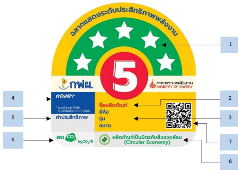
รูปที่ 5 รายละเอียดฉลากแสดงระดับประสิทธิภาพพลังงาน (ขนาดจริง : กว้าง 45 มม. สูง 45 มม.)
