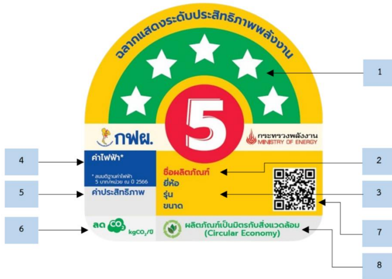
รูปที่ 4 รายละเอียดฉลากแสดงระดับประสิทธิภาพพลังงาน (ขนาดจริง : กว้าง 35 มม. สูง 35 มม.)
