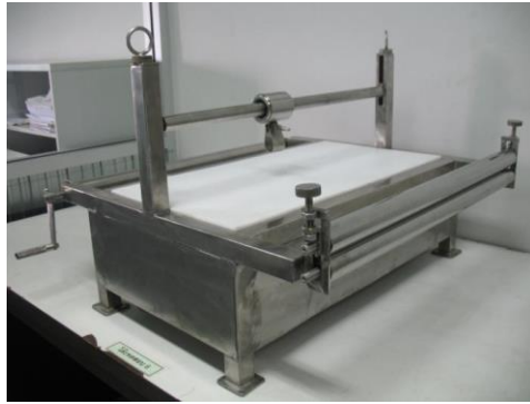
รูปที่ 5 แทนทดสอบการรีด
