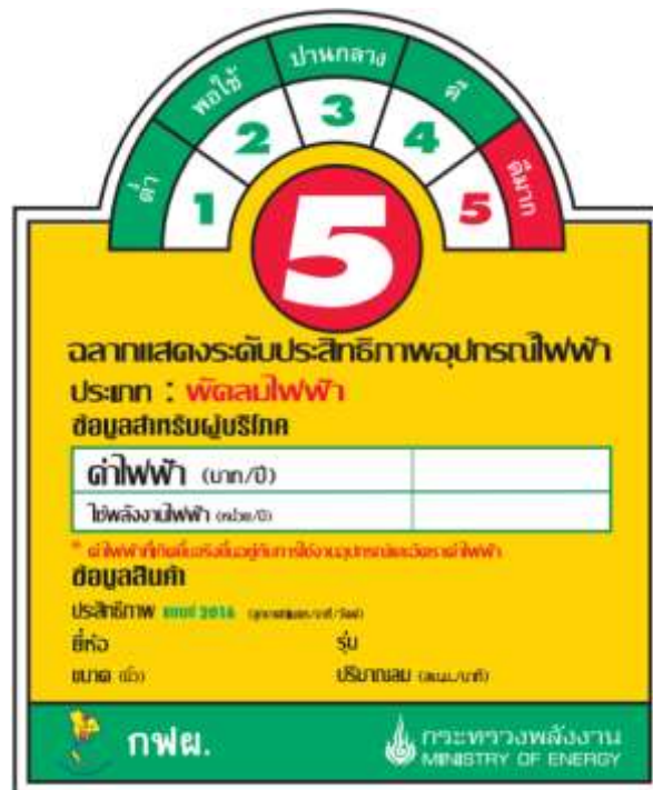
พัฒนไฟฟ้าชนิดตั้งโต๊ะ ตั้งพื้น และติดผนัง เกณฑ์ปี 2016 (ขนาดจริง กว้าง 58 mm. สูง 71mm.)
