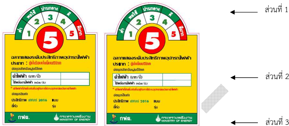
รูปที่ 2 ฉลากแสดงระดับประสิทธิภาพอุปกรณ์ไฟฟ้า ตู้น้ำร้อนน้ำเย็นบริโภคและตู้น้ำเย็นบริโภค (ขนาดจริง สูง 71 มม. กว้าง 58 มม.)
