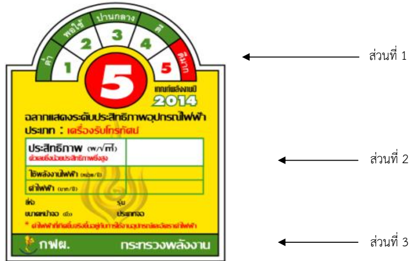
รูปที่ 1 ฉลากแสดงระดับประสิทธิภาพอุปกรณ์ไฟฟ้า เครื่องรับโทรทัศน์ (ขนาดจริง : สูง 57 มม. กว้าง 46.5 มม.)
