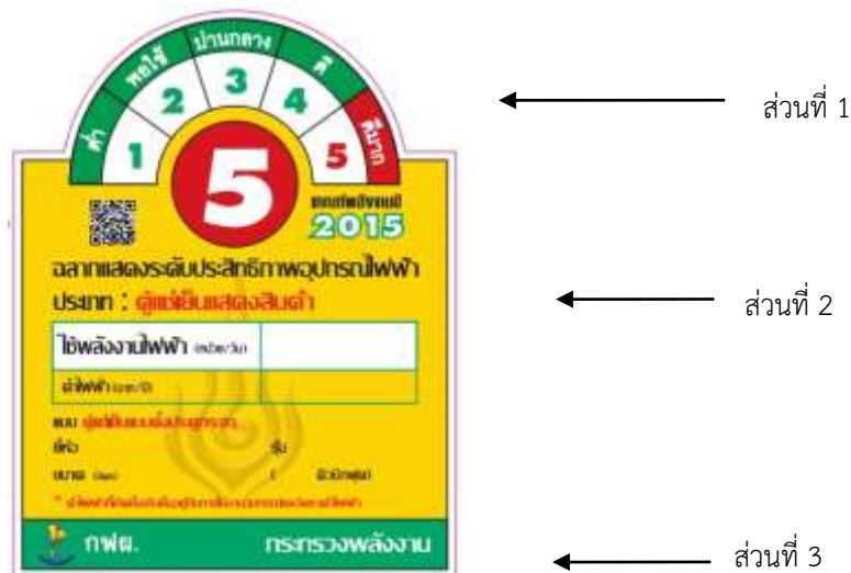
รูปที่ 1 ขนาดย่อส่วนของฉลากแสดงระดับประสิทธิภาพอุปกรณ์ไฟฟ้า (ขนาดจริง: กว้าง 97 มม. สูง 128 มม.)
